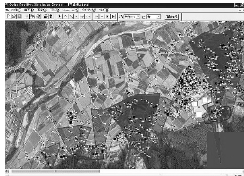
図4 土砂災害ハザードマップを考慮した避難シミュレータ
